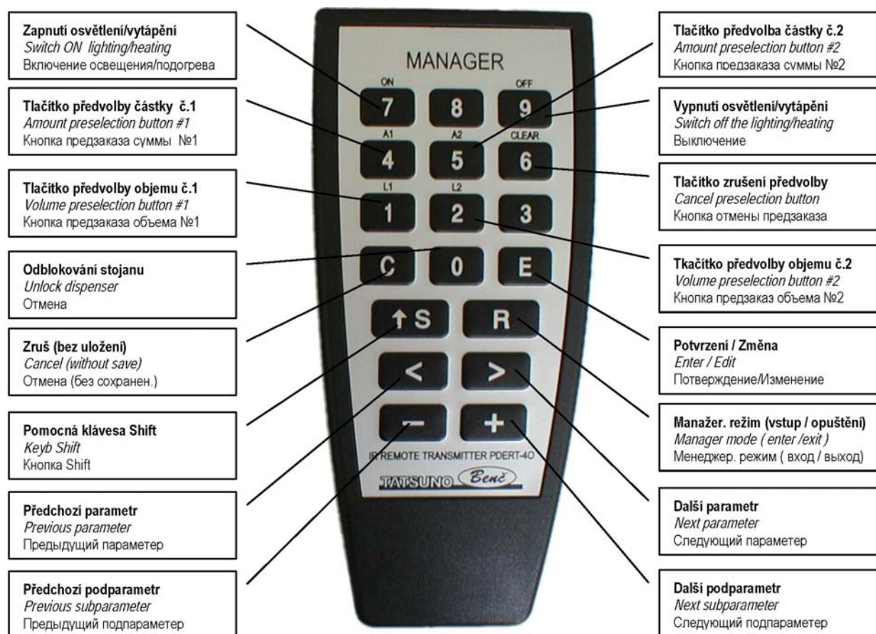
Obrázek 16 - Popis kláves dálkového ovladače PDERT-40
