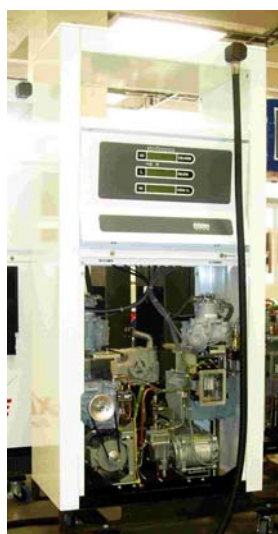
Obrázek 23 - Odkrytý stojan SDA 2222.E
